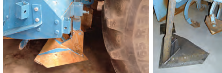
Verschillende typen injectiesystemen met ganzenvoeten
