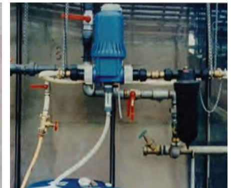
Een pomp kan ook rechtstreeks op het vat met metam worden aangesloten (meest gebruikelijke methode)
