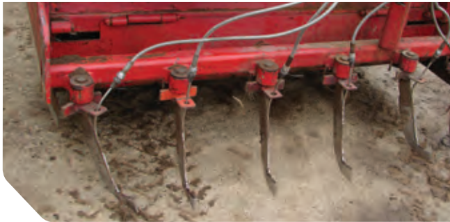
Korte injectiemessen voor gebruik in de serre
