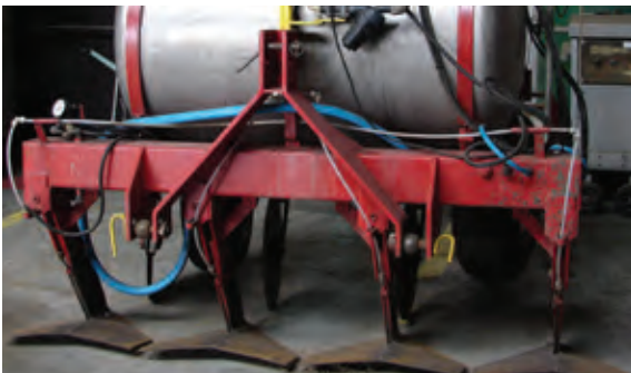
Verschillende typen injectiesystemen met ganzenvoeten
