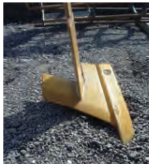
Verschillende typen injectiesystemen met ganzenvoeten
