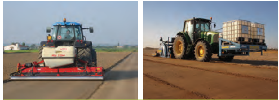
Voorbeeld van het bodemoppervlak na een werkgang met een aandrukrol
