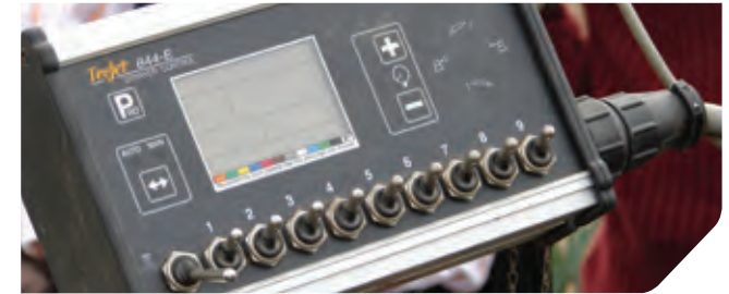
Elektronische debietregeling voor individuele injectiekanalen (TeeJet)
