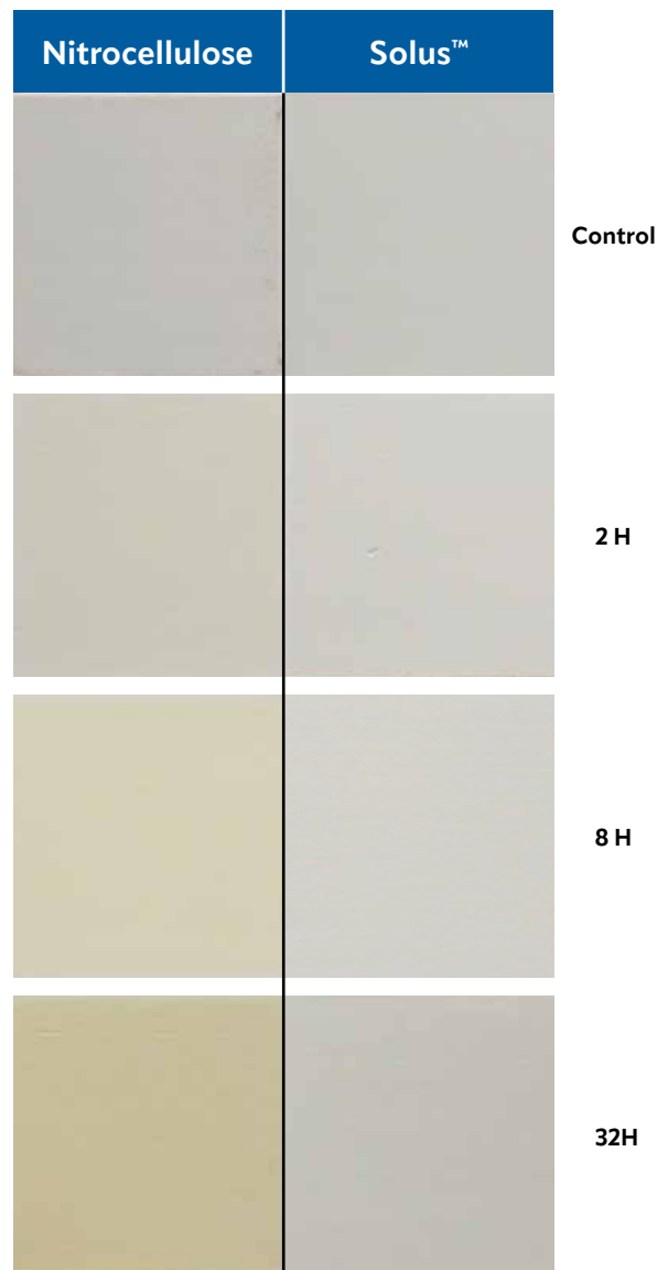
Figura 1. Estabilidad UV de la laca para madera blanca en la que se aplicó Eastman Solus™ en comparación con la nitrocelulosa
