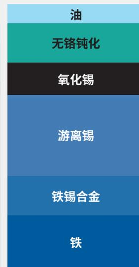
电镀马口铁 (ETP) 和无铬钝化替代型 (CFPA) 马口铁的经典钝化工艺
